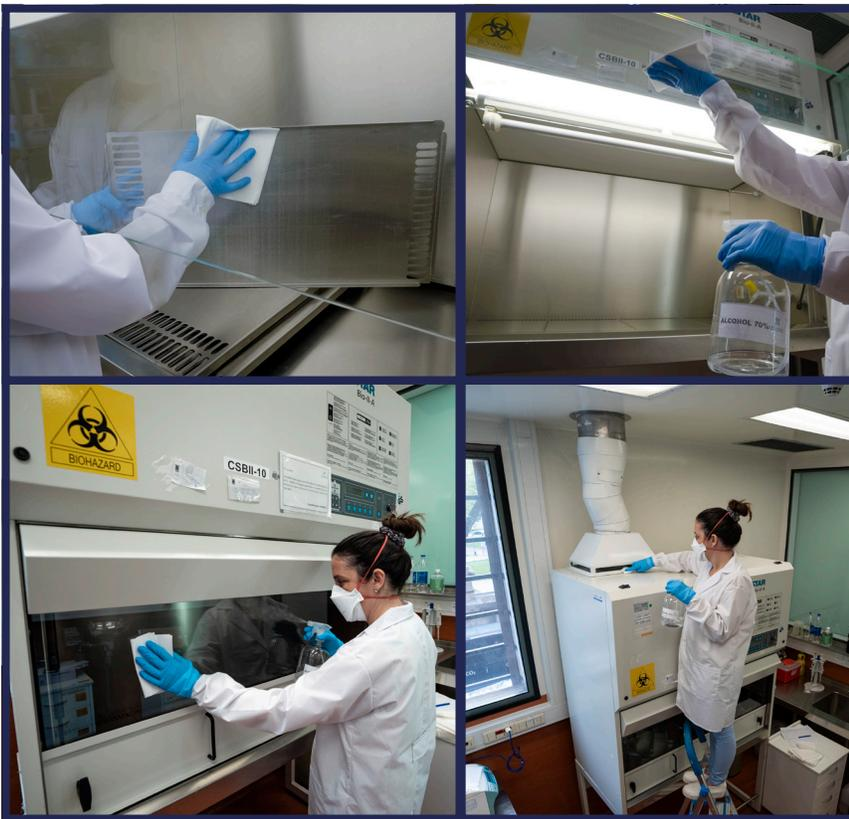
**LIMPIEZA INTERNA Y EXTERNA DE PARTES DE LA CABINA DE SEGURIDAD BIOLÓGICA**
