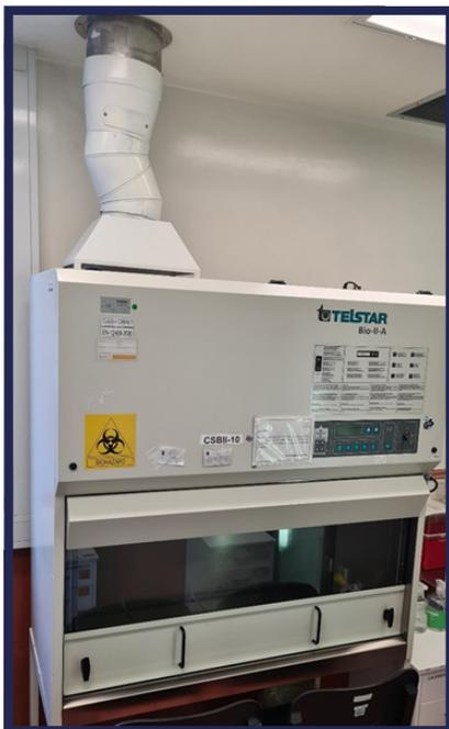
**CABINA DE SEGURIDAD BIOLÓGICA CLASE II TIPO A2 CON CONEXIÓN TIPO CANOPY/ DEDAL**
